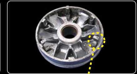
スライドピースが破損した事で、ランププレートがリブにダメージをあたえてしまったプリー
