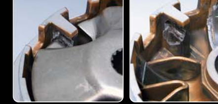
右の写真はスライドピースが破損したことにより鉄製であるランププレートが直接リブに干渉してしまい、完全にリブが無くなってしまった状態。これでは変速どころか、動力を受けることが出来ず、動力を伝えることが出来ません。
