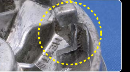
破損したプリーリブ
