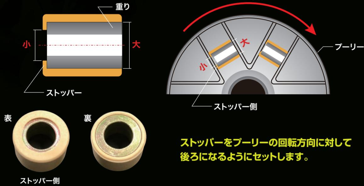
ストッパーをプリーの回転方向に対して後ろになるようにセットします。
