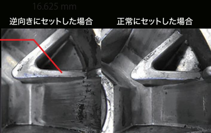
ウェイトローラーの向きが正しく装着されていなかったために、ウェイトローラーの金属製である重り部分がアルミ製であるプリーのローラガイド部分と接触し磨耗してしまいます。
