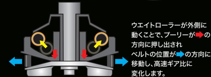
ウエイトローラーが外側に動くことで、プーリーが→の方向に押し出されベルトの位置が→の方向に移動し、高速ギア比に変化します。
