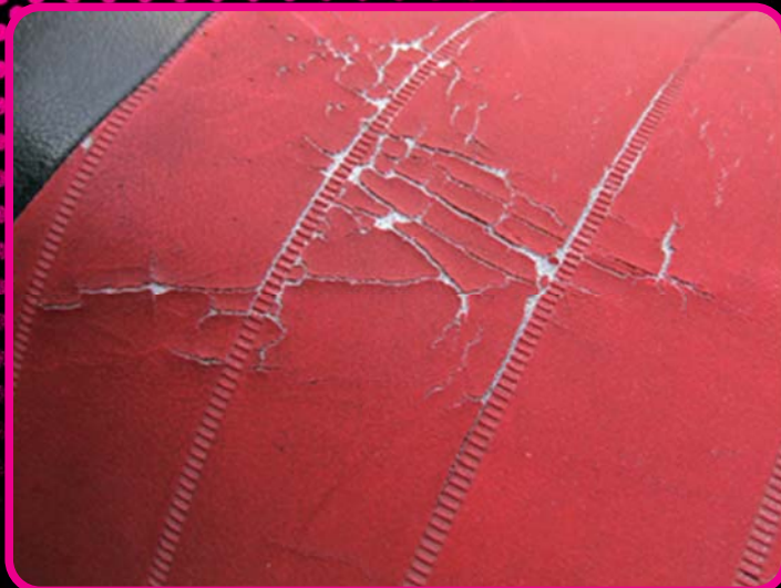
■経年劣化から表皮の部分がひび割れを起こしてしまった状態。
