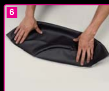
新しいシートカバーを二つに折ります。ズレないように注意して下さい。
