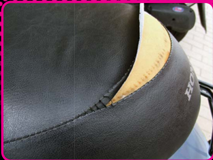
■経年劣化による縫目からの破け、裂け。
