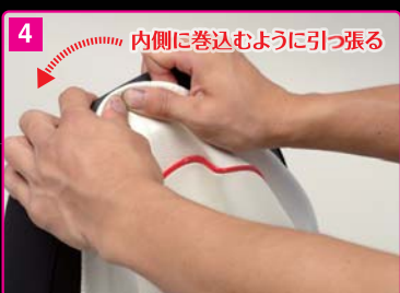
シートの前を確認し、ズレ・シワが出来ないように、後ろ側に引っ張ります。
