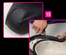
もしシワが入ってしまった場合は、タッカーの針を抜き、再度引っ張りながら張替を行って下さい。
