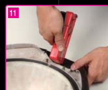
中心の切り込みを目安にして、前側をタッカーで留めます。角になっている箇所はシート裏側にシワがでないようにします。
